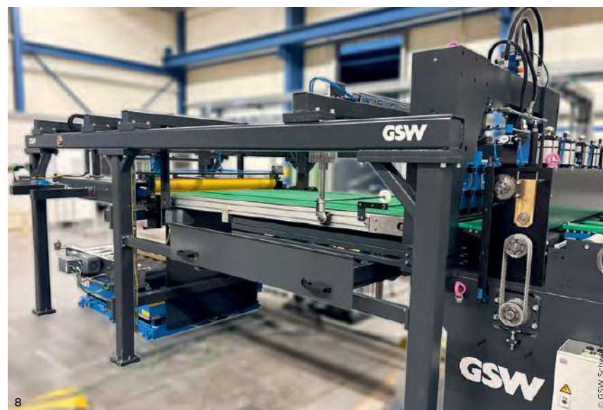
8 Entnahmevorrichtung für Schrott und Probenbleche vor dem Stapler. Rechts im Bild ist die Dachschnitt-Schere zu sehen. Das Förderband kann pneumatisch hochgeklappt werden. Dann kann entweder Schrott in einen Container, oder ein Probenblech in die Schublade gelangen.
