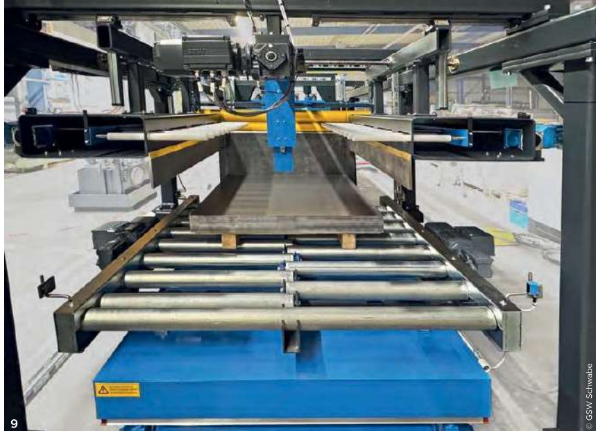
9 Der Hubtisch ist beim Kunden im Boden versenkt montiert. Zu sehen sind die Fingerrollen, die zur Seite fahren und das Blech auf den Stapel sinken lassen, außerdem in der Mitte der Hinteranschlag, der für präzises Ablegen sorgt.
