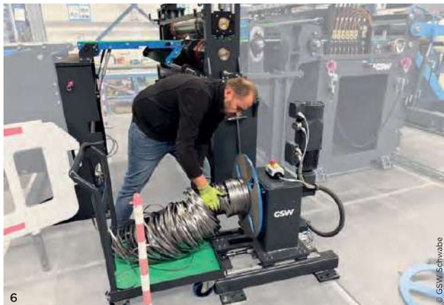
6 Der Saumschrott wird drehmomentgesteuert aufgewickelt, die Haspel ist konisch, so dass das Abziehen des Saumschrotts einfach ist. Da ein Kran nicht nutzbar war, dient ein passend konstruierter Wagen dem Abtransport. Im Hintergrund ist die Besäumschere zu sehen. 7 Der Bandeinlauf in den Walzenvorschub: Unter den grünen Abdeckungsstreifen sind die Präzisionskugellager zu sehen, die das einlaufende Blech für die Schere präzise ausrichten.
