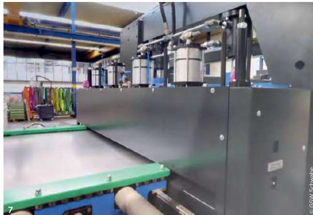
6 Der Saumschrott wird drehmomentgesteuert aufgewickelt, die Haspel ist konisch, so dass das Abziehen des Saumschrotts einfach ist. Da ein Kran nicht nutzbar war, dient ein passend konstruierter Wagen dem Abtransport. Im Hintergrund ist die Besäumschere zu sehen. 7 Der Bandeinlauf in den Walzenvorschub: Unter den grünen Abdeckungsstreifen sind die Präzisionskugellager zu sehen, die das einlaufende Blech für die Schere präzise ausrichten.
