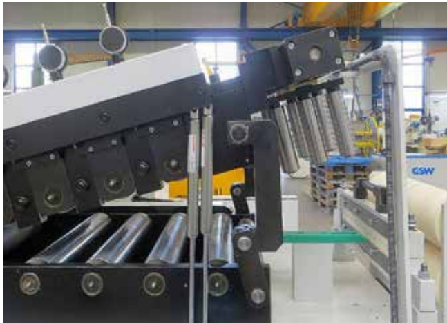
Der Alligator-Richtkopf sorgt für gute Zugänglichkeit, zum Beispiel für die Reinigung der Walzen. © GSW
