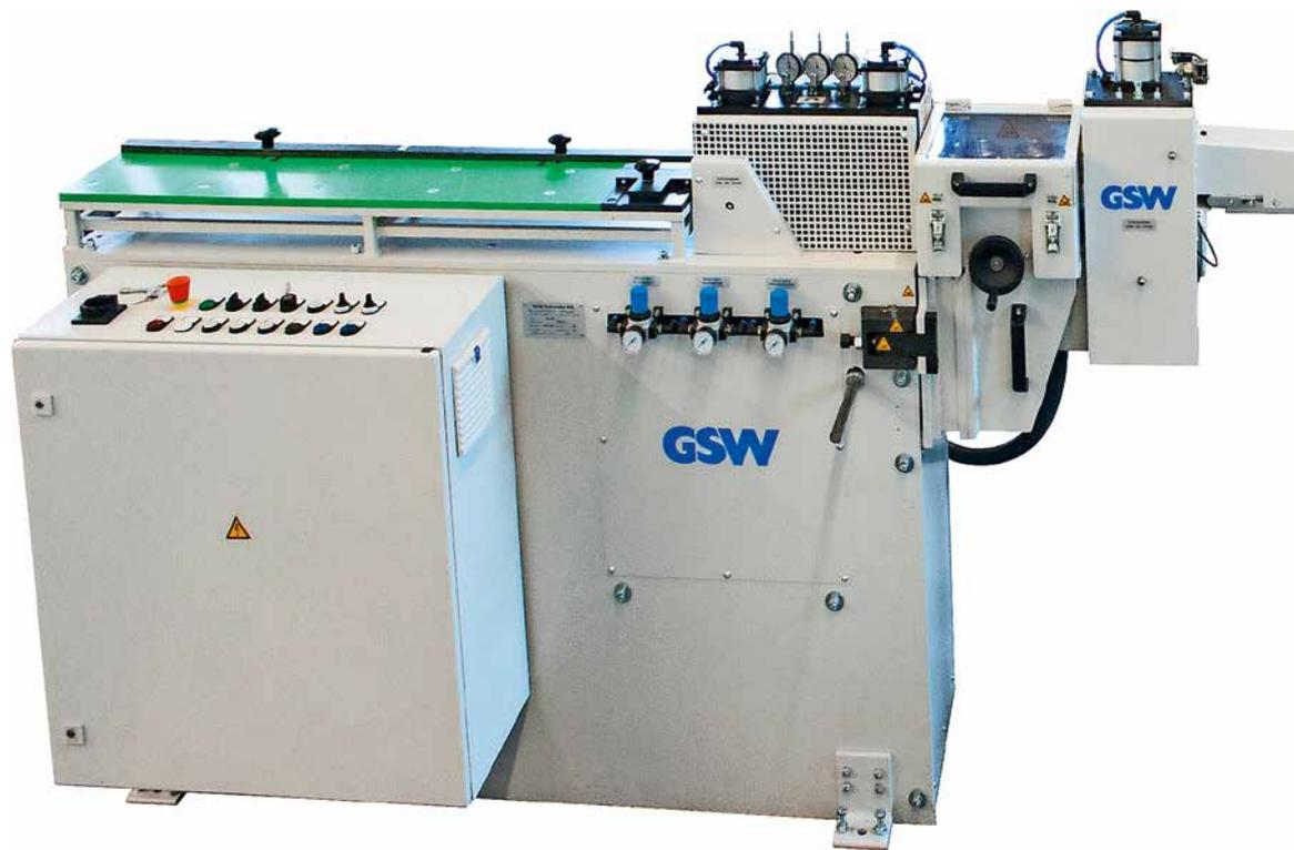
Gesamtansicht der Maschine mit Auflagetisch (li.), Walzerichtmaschine, Säbelrichtwerk, Treiber und Auswerfer-Förderband.
