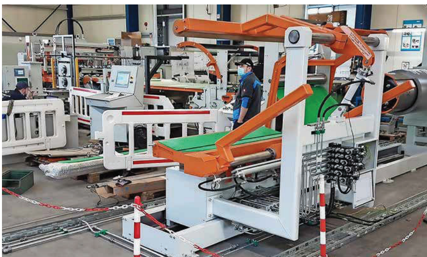
Entladesystem mit verfahrbarem Prisma und stufenlos verstellbaren, kombinierten Sicherheits-Abschiebearmen und mitfahrender Anpreszrolle.
