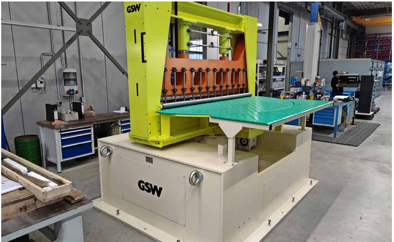
Mit der GSW-Schere lassen sich 1.524 mm (60 Zoll) breite Streifen mit 30° Schwenkung zuschneiden.
