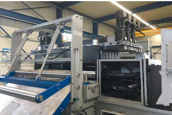
Rückseite der Richtmaschine mit Verteilergtrieben und schweren Gelenkwellen. Auch die 160er Einzugsrollen sind abgestützt.
