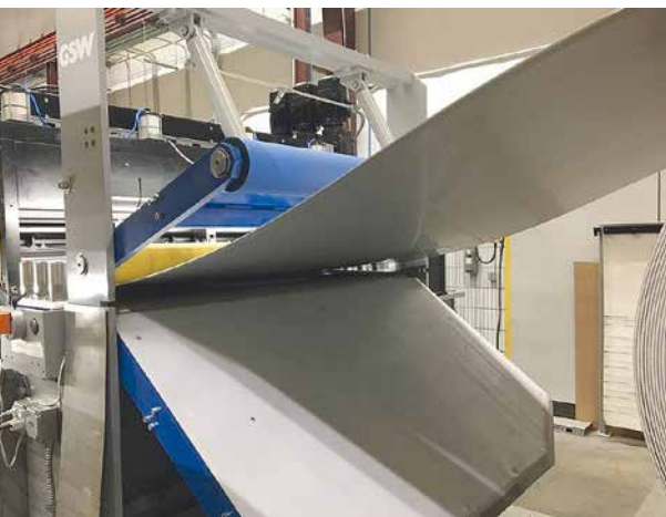
Produktion in den USA. Deutlich erkennbare Querwölbung beim einlaufenden Material.
