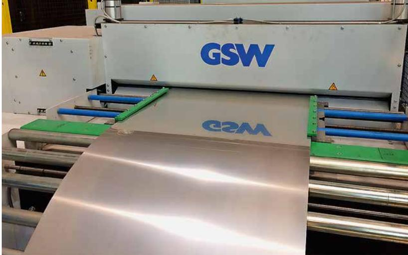
Einlauf in die Vorschubrichtmaschine mit Präzisionsbandführung.
