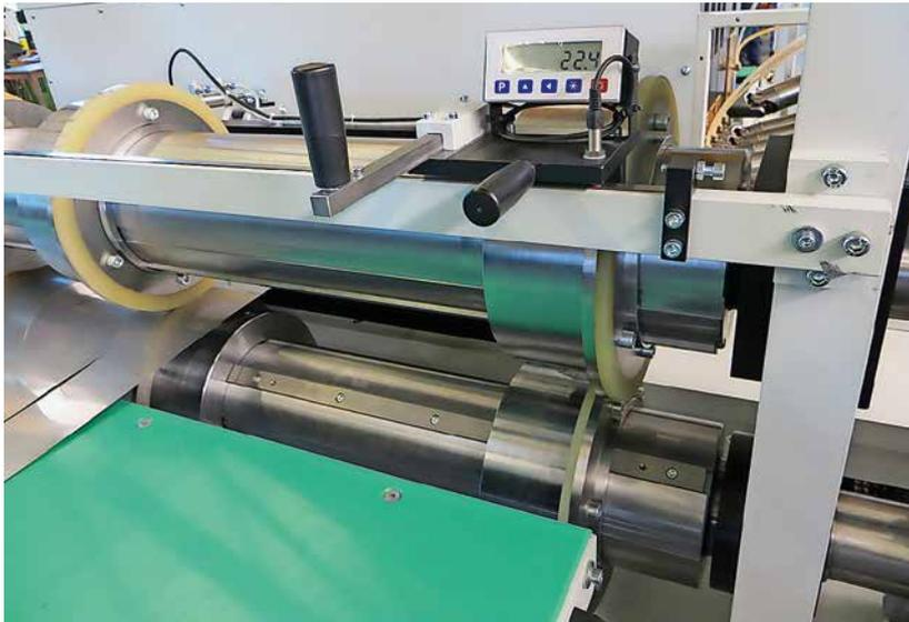
Digitale Einstellhilfe für die Kreisschermesser der Längsteilschere.
