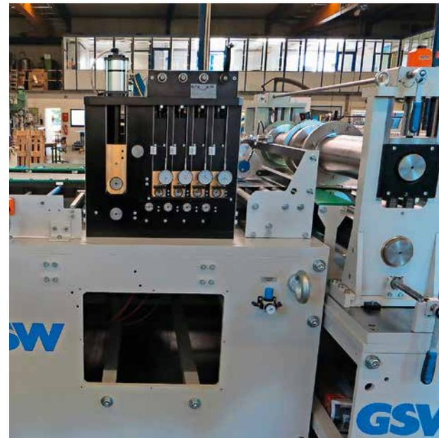
Detail der Vorschubrichtmaschine mit Messrad und Übergabe in die Längsteilschere.
