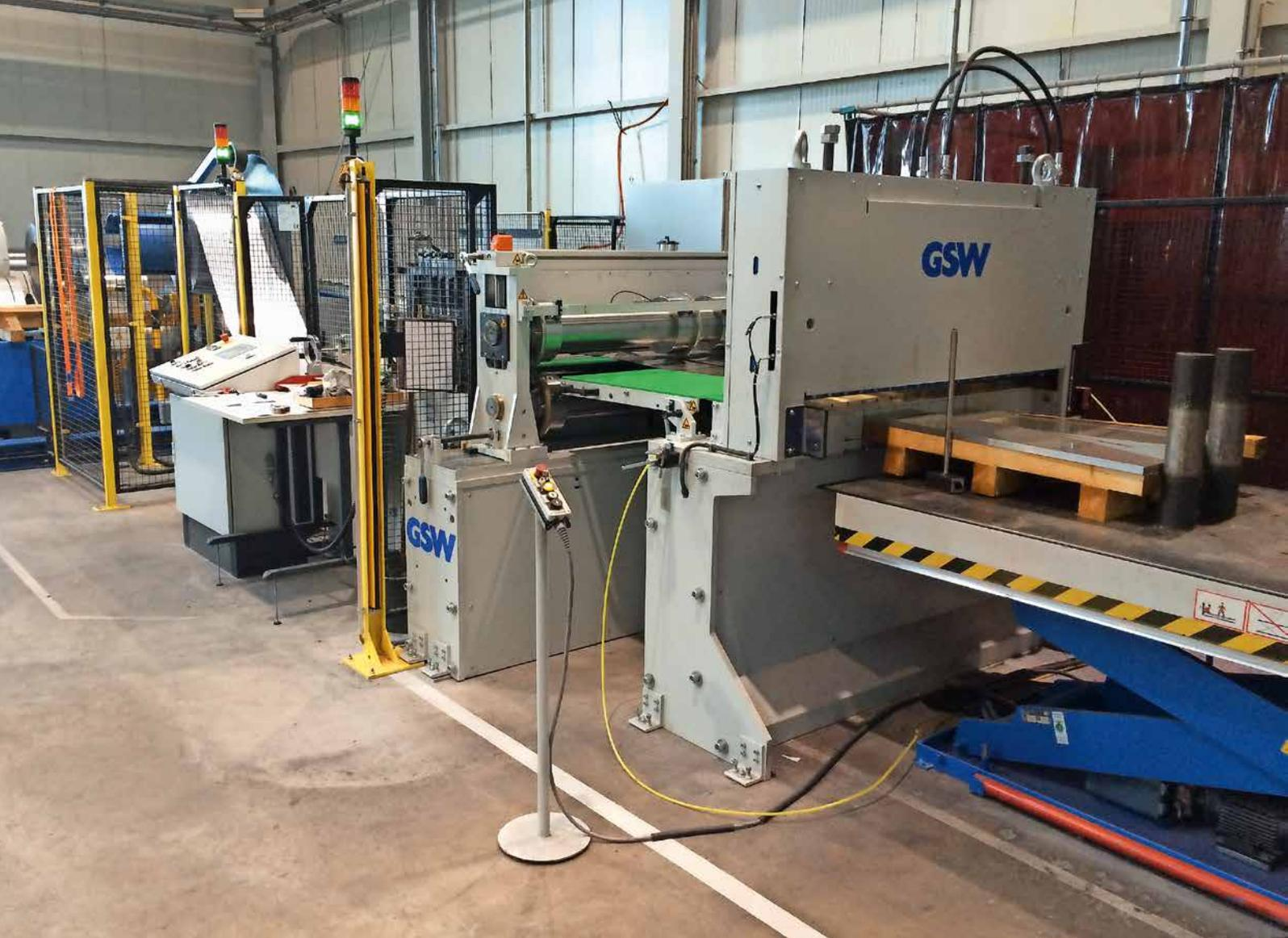
Querteilanlage bei einem Anwender für die Herstellung von Plattenwärmetauschern.
