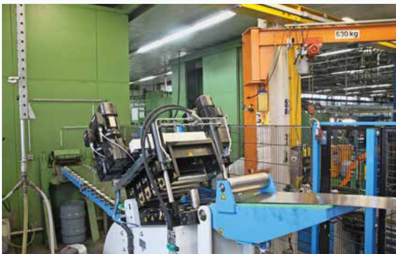
Mit Einführtisch und Alligatorkopf ist die Blecheinfädelung ein Kinderspiel.
