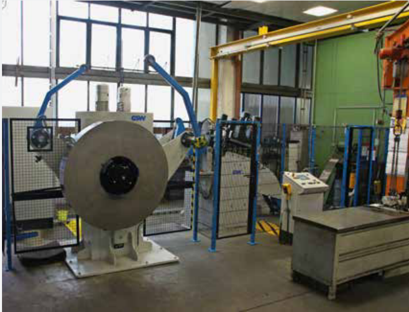
Gesamtansicht der Bandanlage für 2 x 4 t, 320 x 2,3 mm höherfeste Bleche und 20 m/min Produktionsgeschwindigkeit; Beladeseite ist Bedienerseite.
