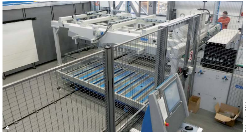
3 Entspannung: Präzisions-Vorschubrichtmaschine mit automatischer Schmierung 4 Prima-Power-Kassettenwagen fährt unter GSW-Abstapelung.
