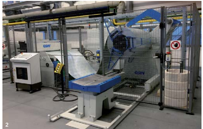
1 Die Linie von der Kantine aus: links das Prima-Power-Lagersystem 2 GSW-Querteilanlage Kompakt mit 12-t-Haspel mit Ladestuhl und Spreizringen
