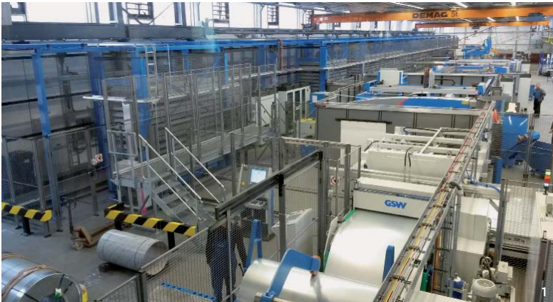
1 Die Linie von der Kantine aus: links das Prima-Power-Lagersystem 2 GSW-Querteilanlage Kompakt mit 12-t-Haspel mit Ladestuhl und Spreizringen
