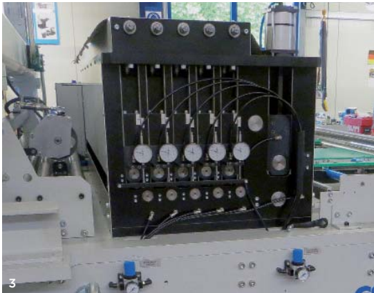
3 Entspannung: Präzisions-Vorschubrichtmaschine mit automatischer Schmierung 4 Prima-Power-Kassettenwagen fährt unter GSW-Abstapelung.
