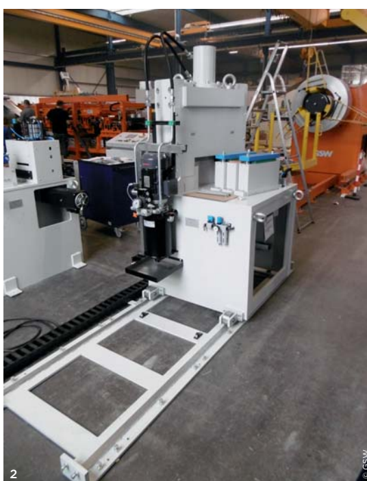
1 Die Trennschere entwickelt etwa 200 Kilonewton Schnittkraft.
