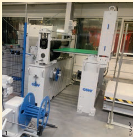
1 Die zentralen Einrichtungen der Anlage sind die Längs- und die Querteilschere. 2 Zur Weiterverwendung des Materials: Abstapeltisch und Saumwickler mit Bremsen.
