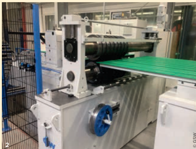
1 Die zentralen Einrichtungen der Anlage sind die Längs- und die Querteilschere. 2 Zur Weiterverwendung des Materials: Abstapeltisch und Saumwickler mit Bremsen.
