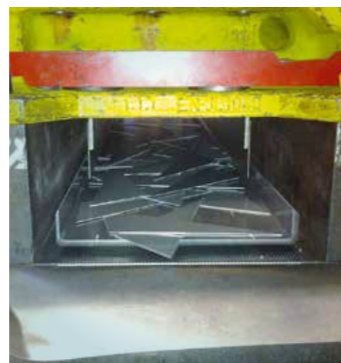
Links: vorbereitetes Werkzeug mit großen Schrott-Trichtern und jeweils einem PS60-Gerät mit Rinne Rechts: Schrottkanal während der Produktion
