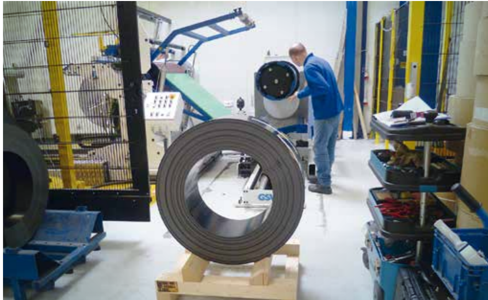
Inbetriebnahme. Sheet metal fan Hubert Albrecht überprüft die automatische Bandklemmung. Die Anlage verfügt jetzt über aktuelle Sicherheit und eine moderne Bandbremse mit halbautomatischer Streifenübergabe
